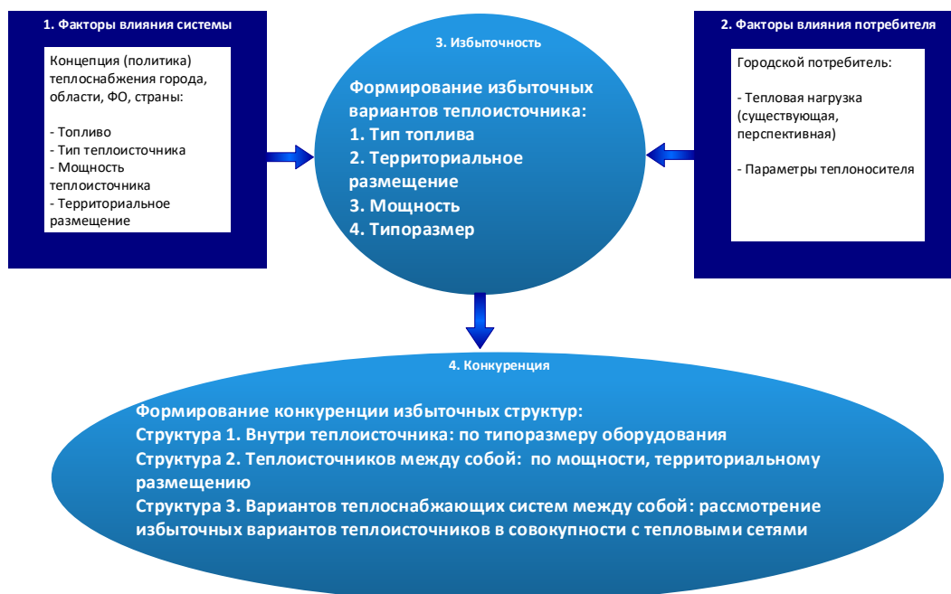
Рис. 1. Схема процесса формирования избыточных вариантов проектируемых ТСС и виды конкуренции избыточных структур.
